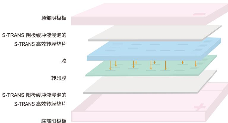
将转印“三明治”结构放置于转印盒的中心，如结构在盒中稍微偏离中心，则无需做移动，放入转印盒后请立即盖上转印盖，确保电气触点紧密配合底座的槽。将盒盖上的销锁杆向盒中心拨动并用力按下盒盖，再放开杆，盖销插入锁定槽。完成后将转印盒滑入主机盒槽中，推至接触联锁并锁定，此时触控屏背景色由亮白色变为灰色。
