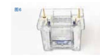
⑧ 向电泳槽的内槽中倒入足够的 MOPS-SDS Running Buffer，使其覆盖上样孔 5-7 mm，在外槽中加入相同的电泳缓冲液以确保适当的冷却。为了获得最好的效果，外槽的缓冲液需要比内槽的位置稍低，不可漫过胶板。使用注射器或其他工具吸取适量 1× 的电泳缓冲液，将上样孔轻轻冲洗干净，去除气泡和残留的储存缓冲液。将蛋白质样品上样、电泳。**推荐电压为 160 V，最高不超过 180 V。**
